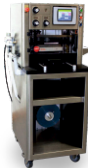
EZ-Blister Autofeed 300~540 cycles per/hr
